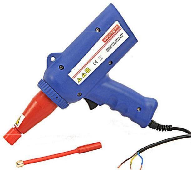
Искровой детектор используется для обнаружения точечных отверстий, пор и трещин толстых покрытий и пленок, в диапазоне от 3 до 30 мм. В основном используется в пластмассовой, резиновой, химической и нефтяной промышленности. Используется для обнаружения в пластиках ПВХ, ПЭ, ПП или ПВДФ.
